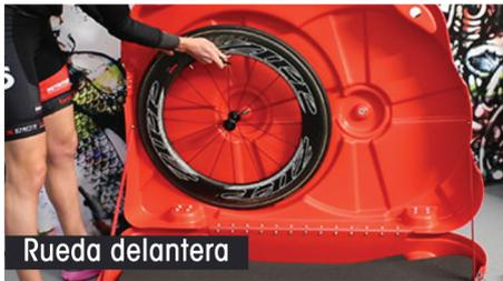
**5** Coloque las ruedas en el espacio designado en la maleta como se muestra en la imagen, la rueda delantera va primero al lado izquierdo, seguido de la rueda trasera al lado derecho.
