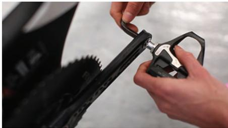
**2** Comience retirando los dos pedales de su bicicleta usando llave Allen o llave para pedales de 15mm.
